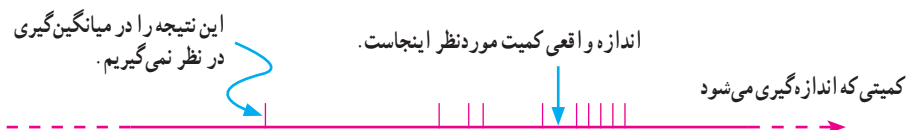
شکل ۹-۱: نتایج اندازه‌گیری شده حول اندازه واقعی. هر نشانه قرمز رنگ، نشان‌دهنده نتیجه یک اندازه‌گیری است.
