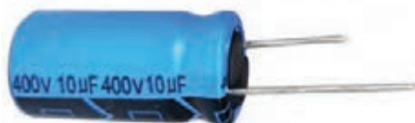
شکل ۱-۴۶ تصویری از یک خازن که روی آن ظرفیت و اختلاف پتانسیل پیشینه قابل تحمل نوشته شده است.
