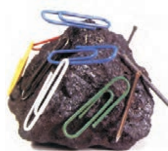
شکل ۳-۱ سنگ آهنربای طبیعی. تالس که اغلب از او به عنوان پدر علم یونان یاد می‌شود، ماده کانی مگنتیت \text{Fe}_3\text{O}_4 را که ویژگی آهنربایی دارد می‌شناخت.
