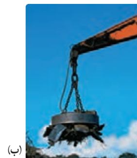
شکل ۳-۲۱ (الف) سیملوله با هسته آهنی (ب) آهنربای الکتریکی صنعتی
